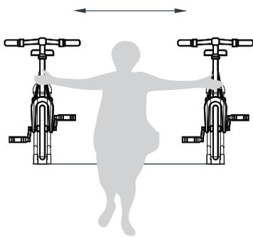
1. Desliza los ciclopuertos hasta que tengas espacio suficiente para introducir la bicicleta.
